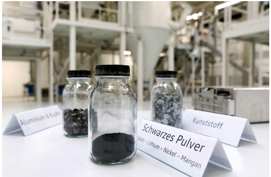
Beim Recycling von Traktionsbatterien können der Elektrolyt, das Aluminium und die Kunststoffe problemlos getrennt werden. Die wertvollen Metalle werden als schwarzes Pulver ausgeschieden. Foto: Volkswagen
