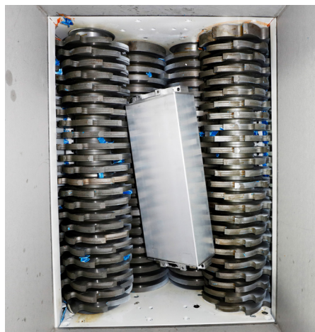
Entweder werden die Batterien mechanisch geshreddert oder zuerst von Hand in die Einzelteile demontiert. Beide Wege sind in der Erforschung. Foto: Volkswagen
